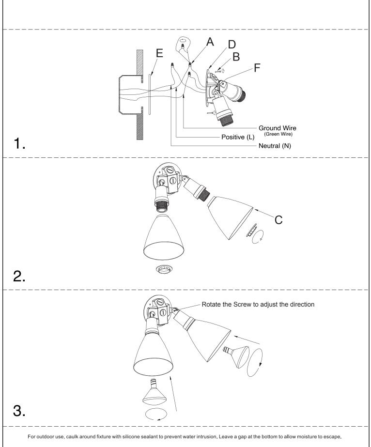
Pour une utilisation à l'extérieur, calfeutrez autour du luminaire avec un scellant en silicone pour empêcher l'intrusion d'eau. Pour une utilisation à l'extérieur, calfeutrez autour du luminaire avec un scellant en silicone pour empêcher l'intrusion d'eau. Laissez un espace au fond pour permettre à l'humidité de s'échapper.
